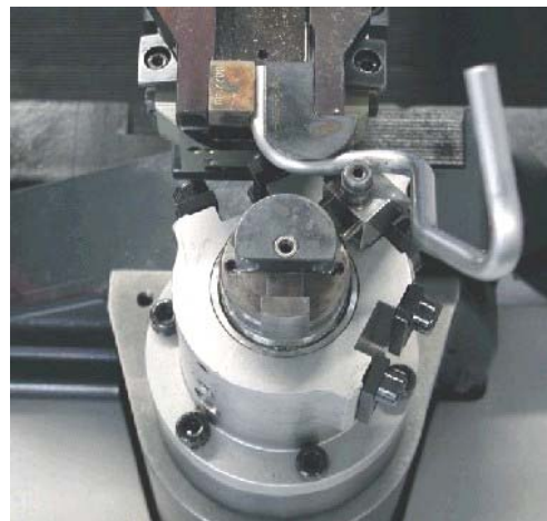
Outil de façonnage avec segment de pliage, façonnage manuel à la pince
