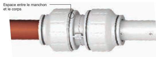
Insérer le tube en butée au travers de la pince et du joint torique. Si le tube est bien coupé d'équerre, le marquage d'insertion sur le tube doit se trouver au niveau de la pince d'accrochage. La connexion est correctement réalisée.
