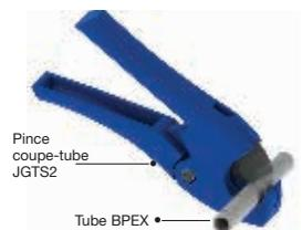
S'assurer que le tube est propre et ébavuré pour éviter tout dommage au joint torique, notamment avec du tube cuivre. Couper le tube d'équerre. Pour le tube BPEX, couper en fonction du marquage sur le tube. Nous vous recommandons d'utiliser les pinces coupe-tube JGTS2 ou HDC.
