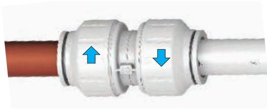
Pousser la pince en butée sur le corps du raccord soit avec les doigts soit avec l'outil de démontage. Maintenir la pince en position et tirer sur le tube pour l'extraire.
