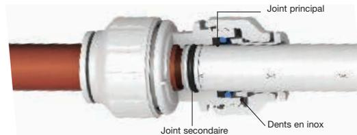
Le joint sur la tête de la fourrure ainsi que celui sur la partie lisse (sauf diamètre 10 mm à queue cannelée) assurent une étanchéité complémentaire.
