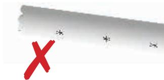
**Ne pas utiliser de tube endommagé ou non ébavuré ce qui peut détériorer le joint torique.**
